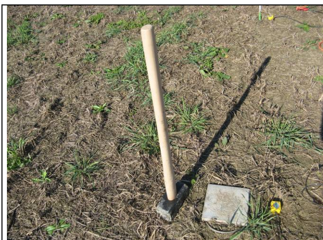
Sistema di energizzazione-battuta.
