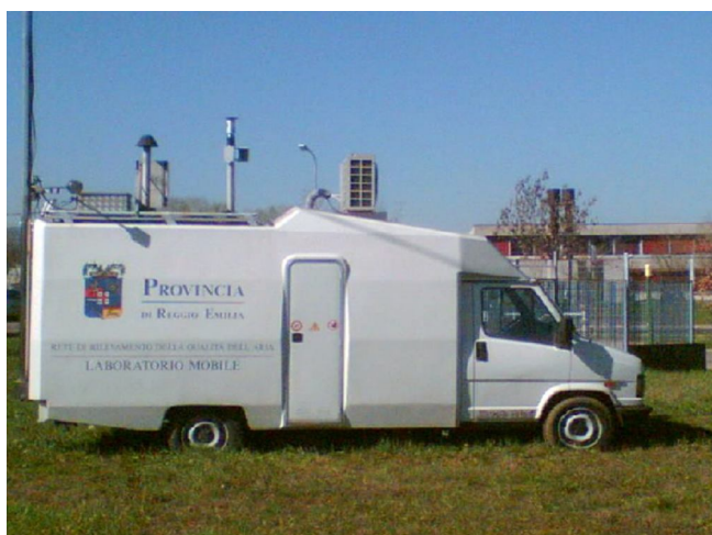
Figura 6.2.6 – Stazione mobile utilizzata per il rilevamento dell'inquinamento atmosferico.
